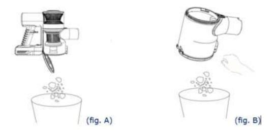
4. Verwijder de filtereenheid: filter, Hepa, stofbak.
