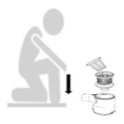
7. Plaatst de stofbak terug in het hoofdapparaat. Draai de stofbak totdat deze vastklikt.
