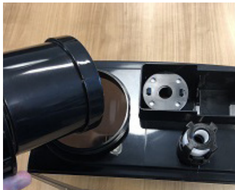
Tapa y filtro del depósito de agua
