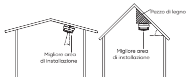
Figura 4-3 Posizione di installazione (2)
